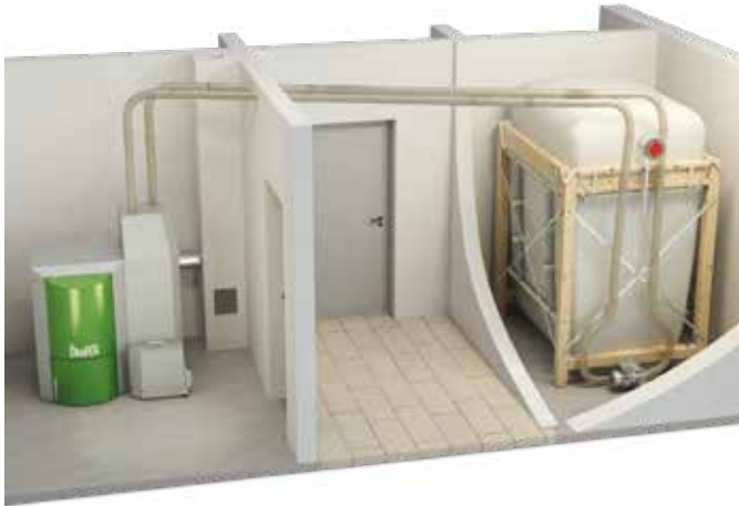
Silo textile à système d'alimentation par aspiration
