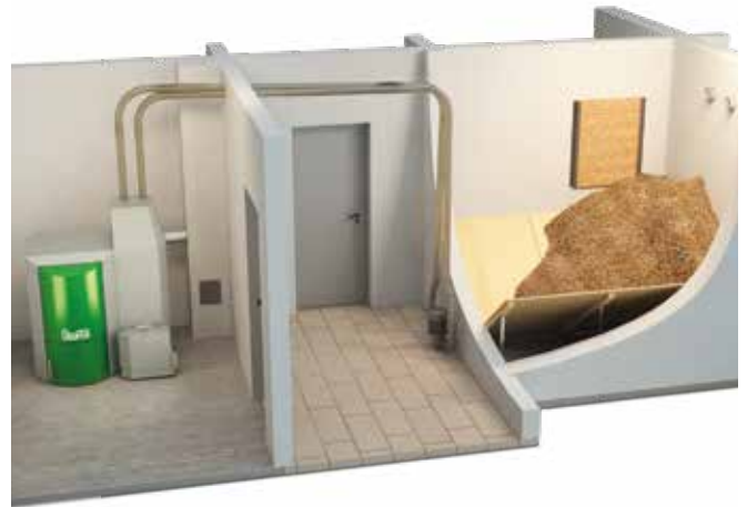
Local de stockage à système d'alimentation par aspiration
